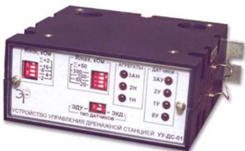
Устройство управления дренажной станцией УУ-ДС-02 предназначено для автоматического управления включением и отключением до трех электронасосов дренажной станции по сигналам от датчиков уровня общим числом до четырех (датчик отключения общий) и обеспечивает:
