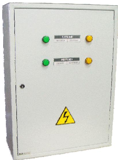
Вводы питания защищены по токам дифференциальными автоматическими выключателями, а от перенапряжения – разрядниками. Обеспечивает раздельное питание аппаратуры КТСМ-01Д и питание собственных нужд блок-контейнера от разных фидеров по трехпроводной схеме (фаза, нейтраль, защитный РЕ проводник). Учет потребляемой электроэнергии производится раздельно по каждому из двух фидеров.
