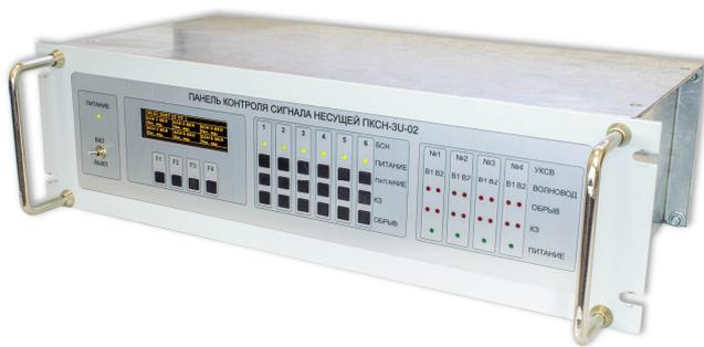
**Панель контроля сигнала несущей ПКСН-3У-02 (ПКСН)** предназначена для организации контроля уровня сигнала несущей частоты радиостанции РС-46МЦ на согласующих нагрузочных резисторах волноводов путей 1, 2 и тупиков линии поездной радиосвязи (ПРС) метрополитена и передачу данных о состоянии волноводов на центральный диспетчерский пункт (ЦДП) по сети Ethernet.
