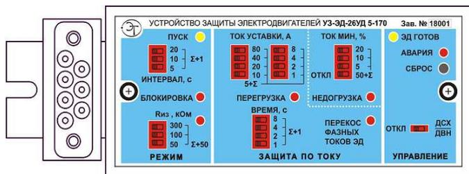
УЗ-ЭД-26У является упрощённым вариантом третьего поколения устройств защиты УЗ-ЭД-36. Функционально превосходит любое из устройств второго поколения УЗ-ЭД-22И, УЗ-ЭД-26И, УЗ-ЭД-27И и может заменять их. Интерфейс подключения идентичен интерфейсу УЗ-ЭД-26И и УЗ-ЭД-27И (через разъём РП10-7).
