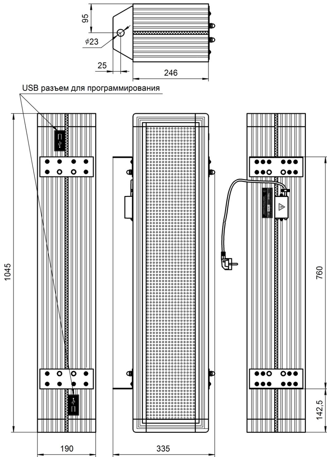
Рисунок 1 – Внешний вид, габаритные и установочные размеры табло
