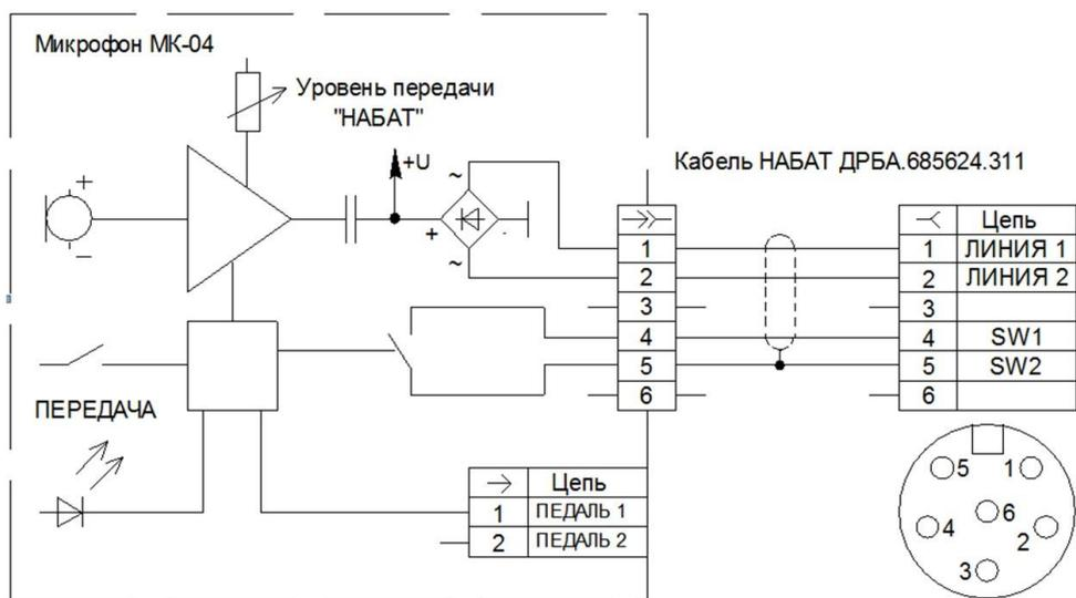
Схема подключения к АГО "НАБАТ"
